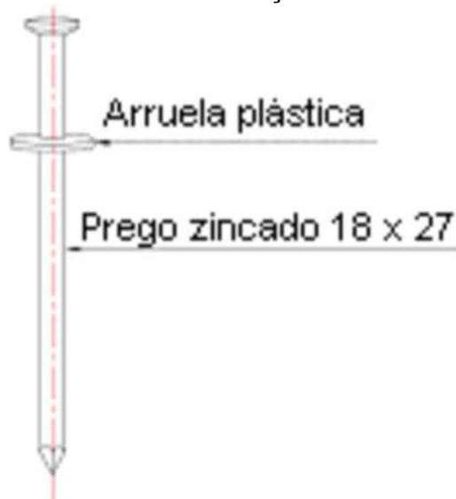
Imagem 43 – Prego zincado utilizado na fixação de telhados tipo pequenas ondas
